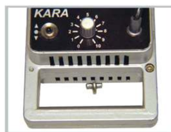
دستگیره حمل، کلید خاموش، روشن و تعیین سمت حرکت، ولوم کنترل سرعت و کابل ورودی برق Carrying handle, Forward / Reverse / Stop switch, Speed control regulator & Main cable
