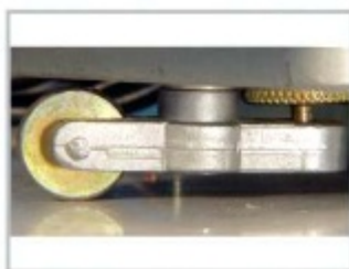
برای برش به وسیله هدایت دستی دستگاه، با آزاد کردن چرخ میانی دستگاه، امکان هدایت دستی و حرکت در جهات مختلف فراهم می گردد. For hand guiding during profile machine is fitted directly on plate (middle wheel is released).
