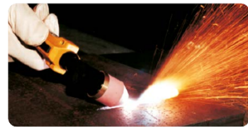
Plasmafugen mit dem Handbrenner PB-S45 WH Plasma gouging with hand torch PB-S45 WH
